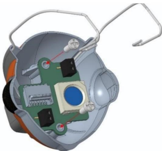
Une fois la tête démontée, on peut visser le module (avec sa nappe) à l'intérieur de celle-ci en le plaçant exactement comme indiqué ci-dessus.
