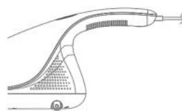
3. Den Griff festhalten, die beiden vorderen Sensorräder mit leichtem Druck nach unten drücken und den Mikroschalter auslösen. Die UV-Lampe wird eingeschaltet, das Gerät geht in den Saug- und Vibrationsmodus, den Modus der Heißlufttrocknung und der Ultraviolettlampen-Sterilisation über.
