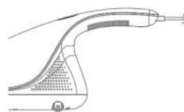
3. Houdt de handgreep vast en druk de voorste twee sensorwielen iets omlaag en druk op de microschakelaar. De UV-lamp is nu ingeschakeld en het apparaat begint te zuigen en vibrerend te kloppen, waarbij de warme luchtfunctie droogt en de ultraviolette lamp voor sterilisatie zorgt.
