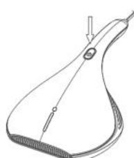
2. Drücken Sie den Knopf zum Starten des Hauptvakuummotors und des Taktmotors. Das Gerät geht dann in den Saug- und Vibrationsmodus. Die heiße Luft wird durch den Heißluftauslass an der Unterseite nach außen geblasen. Das Gerät schaltet dann die Heißlufttrocknungsfunktion ein.
