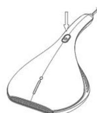
2. Druk de knop in om de hoofd vacuümmotor en de klopmotor te starten, de machine is klaar om te zuigen en kloppen. Warme lucht wordt door de luchtafvoer aan de onderkant naar buiten geblazen. Het apparaat schakelt de droogfunctie met hete lucht in.
