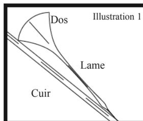
très fin permet d'obtenir l'angle idéal de la lame pour l'affilage dès lors que l'on le dos et le tranchant en contact avec le cuir (cf. : Illustration 1).
