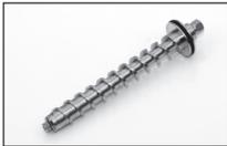
La vis de transport standard convient pour toutes les graines oléagineuses, les grains et les noix. Grâce à la forme particulière de la spire au début de la vis de transport, le produit à presser est broyé et pressé rapidement.
